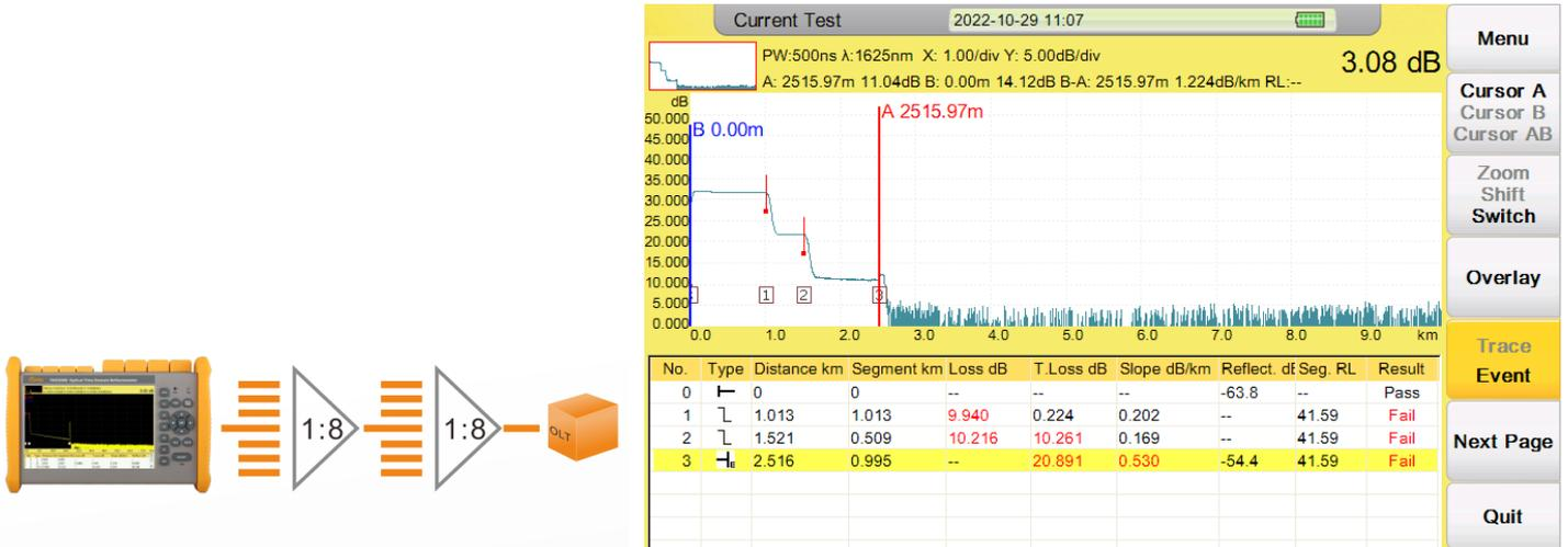
Em particular, com o modo FLM, os usuários podem testar automaticamente sem configurações complicadas para obter os resultados de teste mais precisos e intuitivos. Além disso, o FLM fornece a função Pass/Fail da rede PON, que pode exibir intuitivamente o evento de falha na rede PON. Em um cenário típico de dois splitters 1x8, a distância mais curta entre eles pode ser tanto curta quanto 30m.
